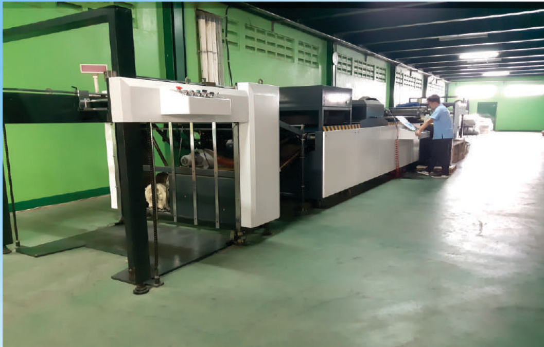
Mesin UV Vernish Huawei 1.200J. Tahun 2016 dengan kapasitas 7.000 lintas/jam.
